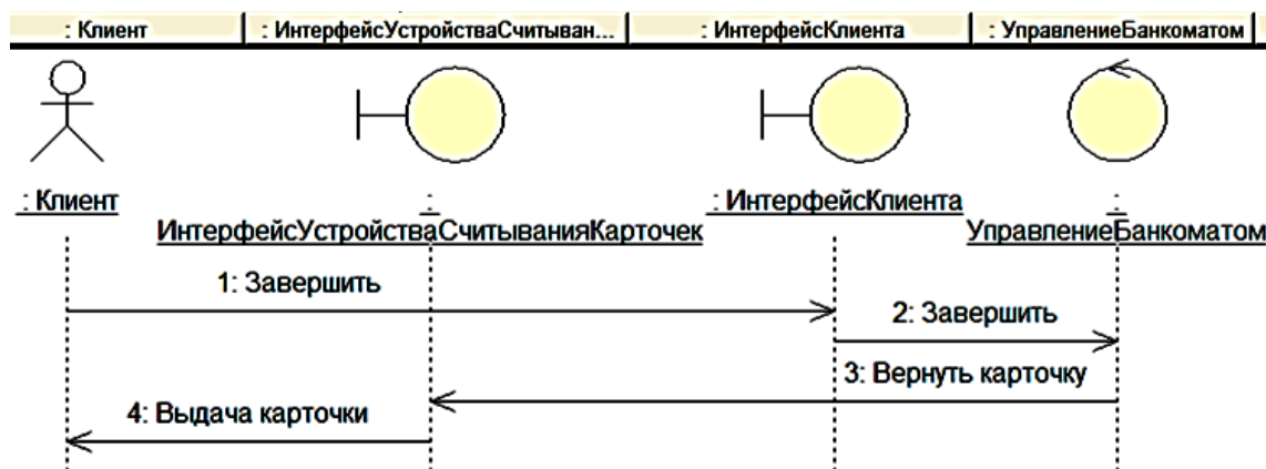
Рис. 5. Диаграмма последовательности для варианта использования Проверить ПИН-код – альтернативный поток A2
