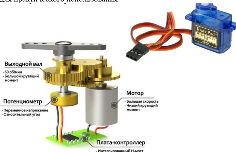
Устройство сервопривода
