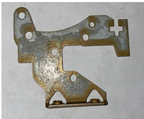
Рис. 1. ДСЕ «Стойка правая ГЖИК.745223.001» с дефектом
